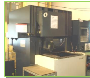
水中ワイヤ放電加工機 U53(牧野フライス製) 520X370X320
