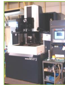
水中ワイヤ放電加工機 U53TJ(牧野フライス製) 520X370X400
