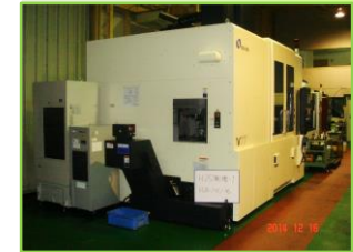
立型マシニングセンター V77(牧野フライス製) 1200X700X650
