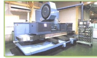
大型立型マシニングセンター MCV860(大阪機工製) 2040X860X720
