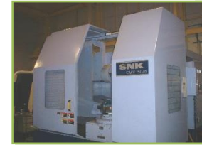
5軸マシニングセンター CMV-50(新日本工機製) 900X880X900
